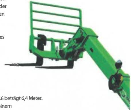
Der Geräteträger ist mit der hydraulischen Tac-Lock-Schnellverriegelung ausgestattet, die einen raschen Wechsel der Anbaugeräte für höchsten Arbeitskomfort garantiert.
