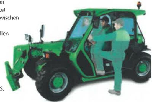
Der Zugang zum Fahrerplatz wird durch den optimalen Abstand zwischen Fahrersitz und Lenkrad und die breite Glastür vereinfacht, deren zwei Elemente bis auf 180° geöffnet werden können.
